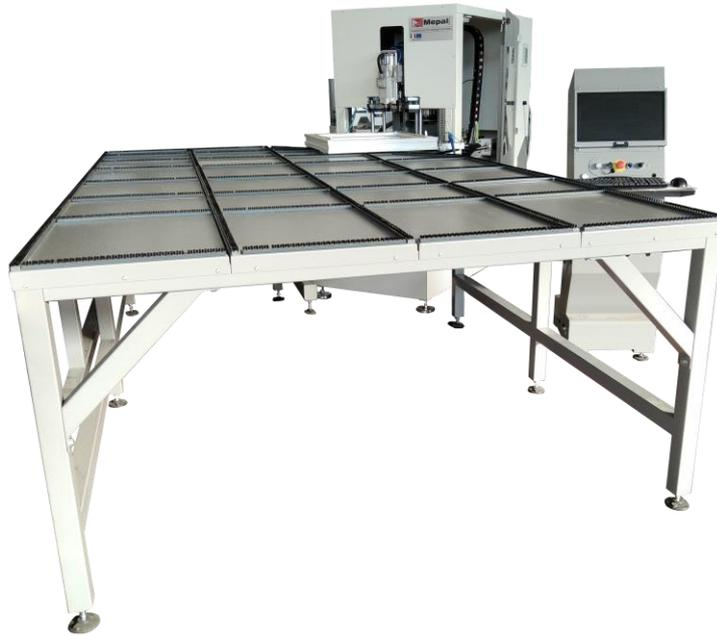
La pulitrice a controllo numerico **TORNADO CNC** con due assi controllati è progettata per la pulizia di telai ed ante in PVC con un ciclo di lavoro automatico.
