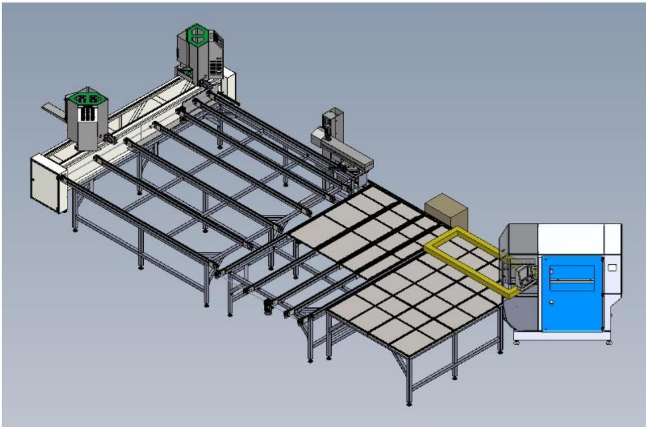
La linea di saldatura e pulitura per finestre in PVC AUSTER è composta da 5 parti principali ed a seconda della saldatrice installata nella linea può gestire telai di varie dimensioni, in modalità completamente automatizzata:
