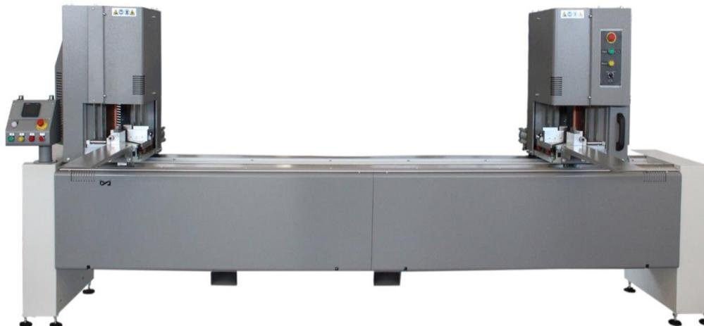
Equipaggiata con cambio rapido delle controsagome. Coltelli limitatori di cordolo regolabili tra 0,2 mm e 2 mm. La temperatura può essere regolata tra 0-350 ° C con termostato elettronico.
